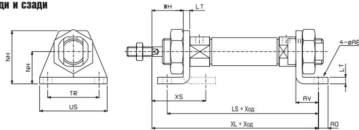
**Фланцевое крепление спереди, фланцевое крепление сзади**
