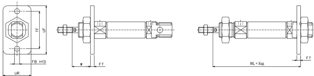
**Поворотное крепление на цапфе спереди, поворотное крепление на цапфе сзади**
